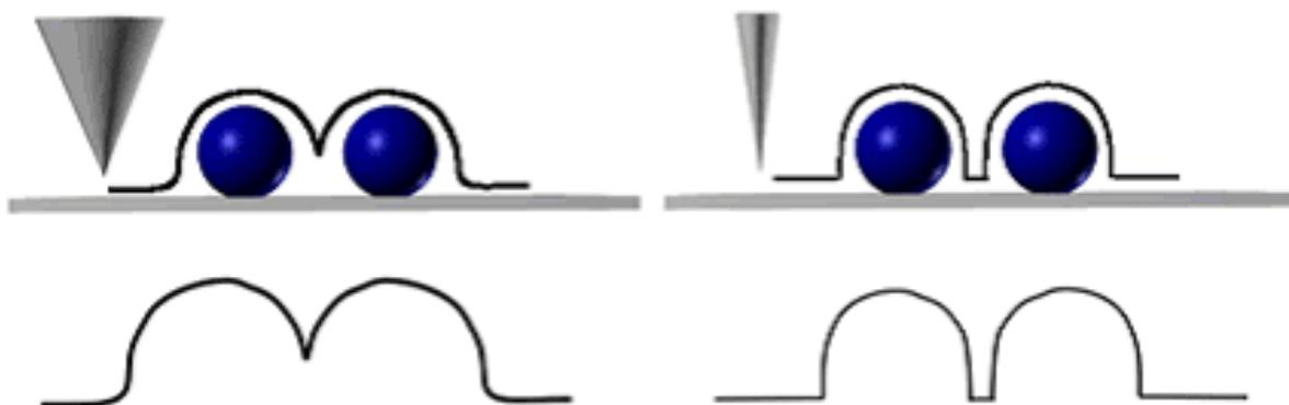
図 14 AFM の分解能 (右のプローブの方が先端が鋭いため、得られるイメージの分解能は高くなる)
